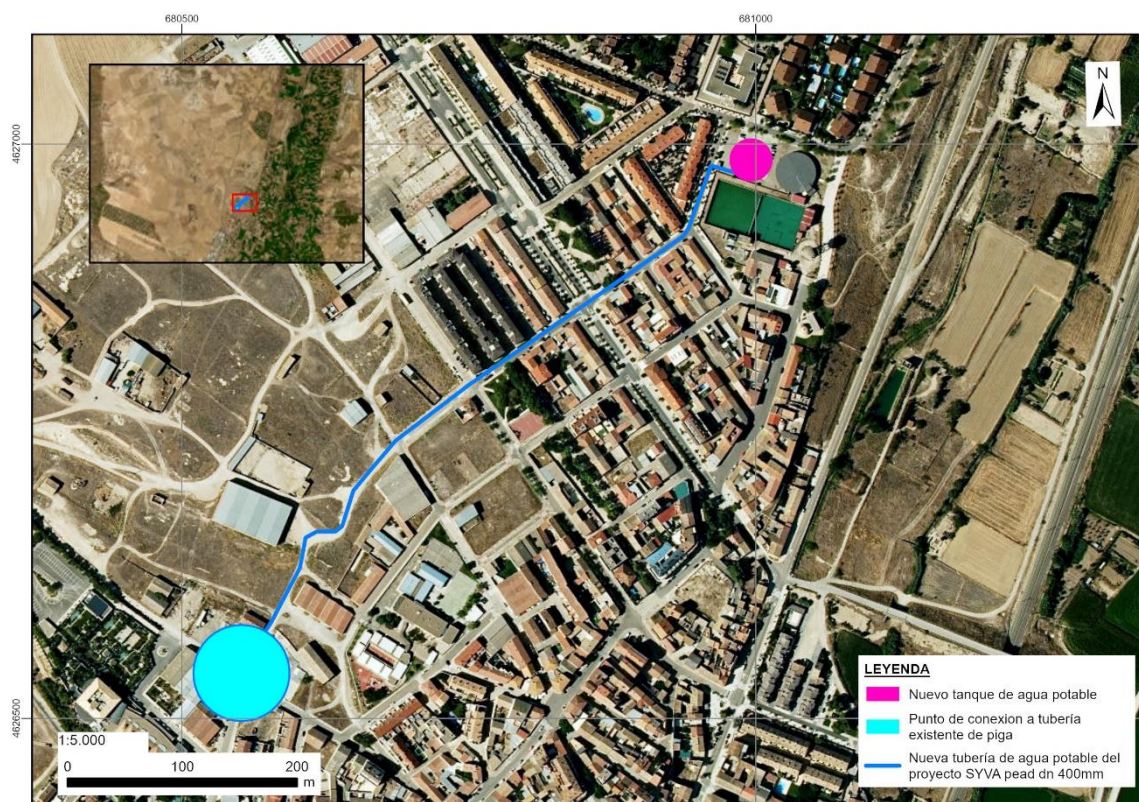
Figura 3.2-4: Esquema del Proyecto de Mejora del Abastecimiento de SyVA. Fuente: SyVA (2024).
